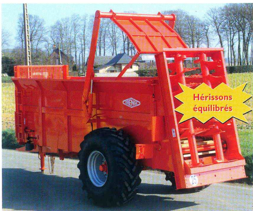
EV120 13 m 3 pneus 23/1 - 26 - porte hydraulique
