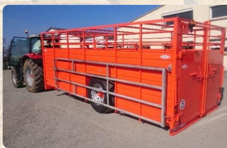
Remorque pose à terre
