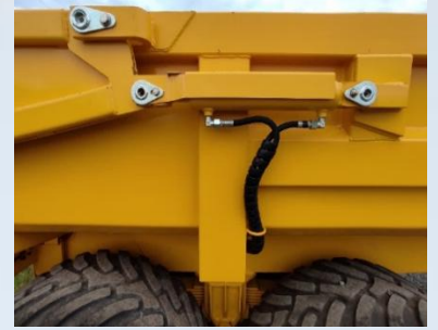
Vérin de porte hydraulique avec protection
