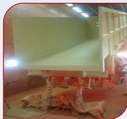
Mise en antirouille d'une caisse de remorque agricole
