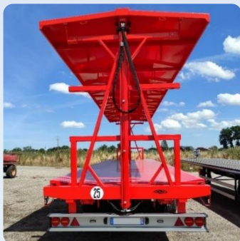
Rallonge arrière hydraulique pour l'aide au chargement (avec ou sans le toit)
