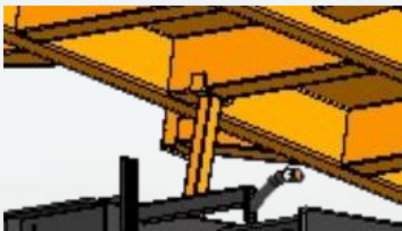
Etai de sécurité (maintenance de la benne, et autres opérations autour de la remorque)
