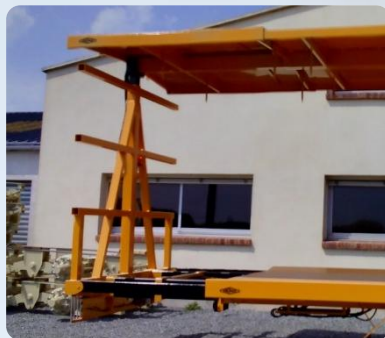
Rallonge arrière hydraulique pour l'aide au chargement (avec ou sans le toit)
