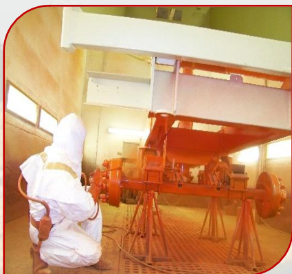
Mise en laque d'un châssis de remorque agricole
