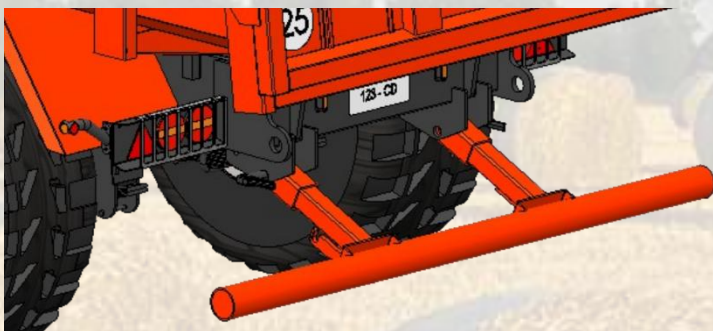
Barre anti encastrement ronde relevable manuellement
