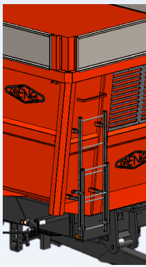
Échelle extérieure galvanisée
