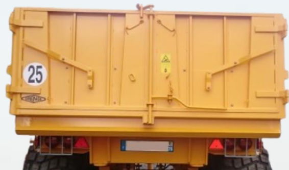
Trappe arrière – porte à ouverture hydraulique en 2 parties
