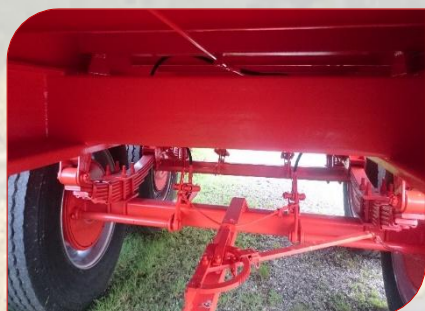
Tandem avec carrée d'essieu renforcé
