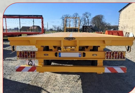
Éclairage et triflash LED + barre anti encastrement indépendante
