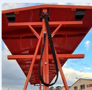
Housse de protection de flexibles (sur rallonge arrière)
