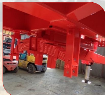
Flèche réglables sur lames de ressort
