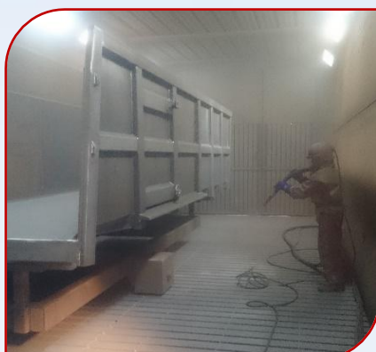
Grenaillage d'une caisse de remorque agricole
