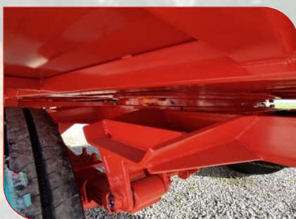
Lame a ressort sur demi tandem avant
