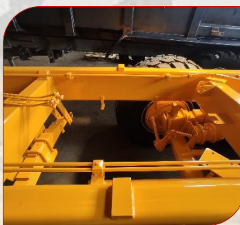
Circuit hydraulique en tube rigide
