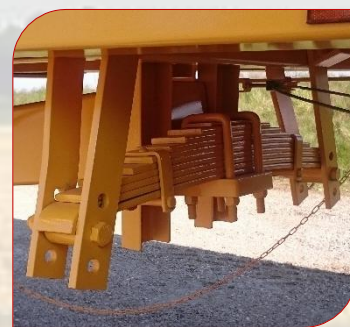
Flèche réglables sur lames de ressort
