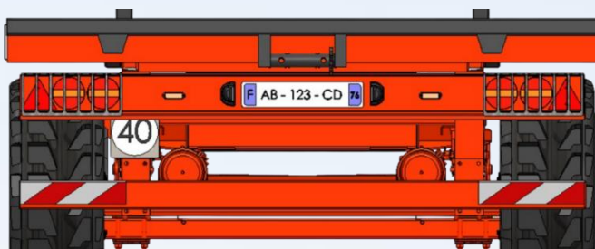
Support d'éclairage en tôle pliée avec grille de feux galvanisée et barre anti encastrement en tube carré de forte section
