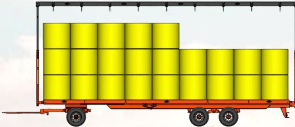
Risque de déformation du montant et du télescope arrière.
