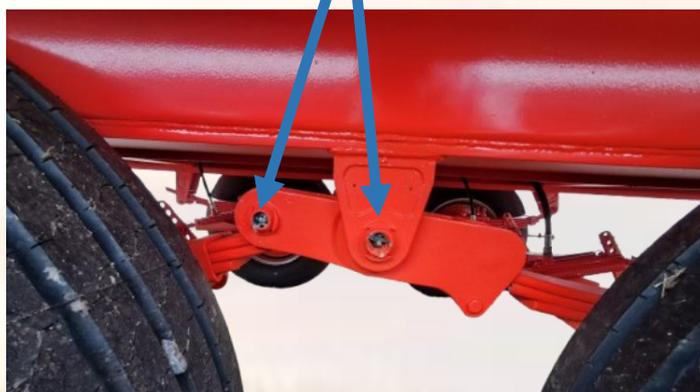
Graisseur de pivots des axes de lames de ressort du demi-tandem.
