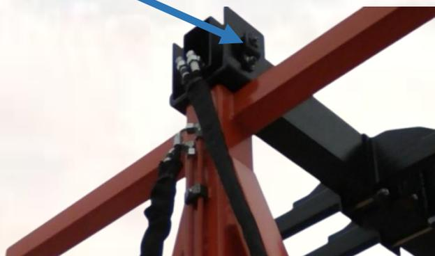
Graisseur de pivots des axes de lames de ressorts et du pivot d'articulation du tandem.
