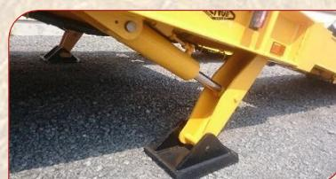
*Béquille anti cabrage arrière hydraulique replié*
