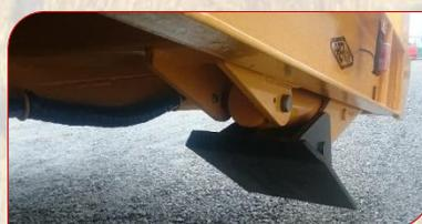
*Béquille anti cabrage arrière hydraulique replié*
