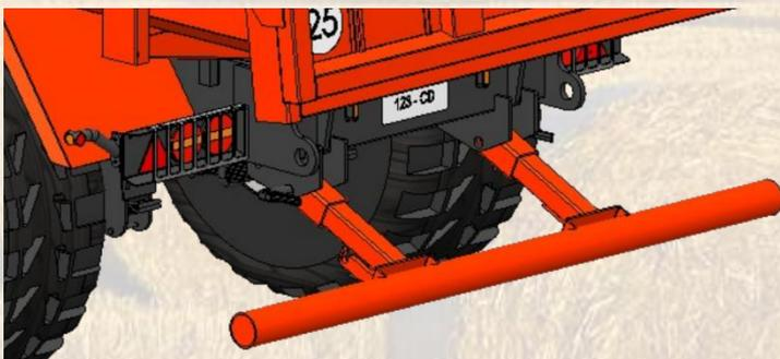
*Barre anti encastrement ronde relevable manuellement*
