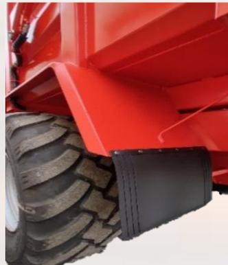
Ailes avec bordures et bavettes en caoutchouc
