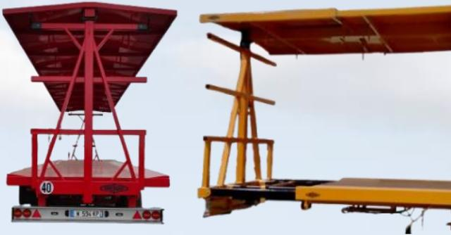
Rallonge arrière hydraulique pour l'aide au chargement (avec ou sans le toit)
