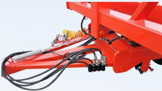
Tube pour rangement des raccords hydraulique
