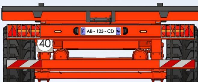
Support d'éclairage en tôle pliée avec grille de feux galvanisée et barre anti encastrement en tube carré de forte section
