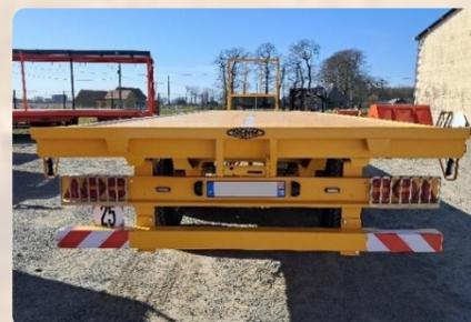
Éclairage et triflash LED + barre anti encastrement indépendante
