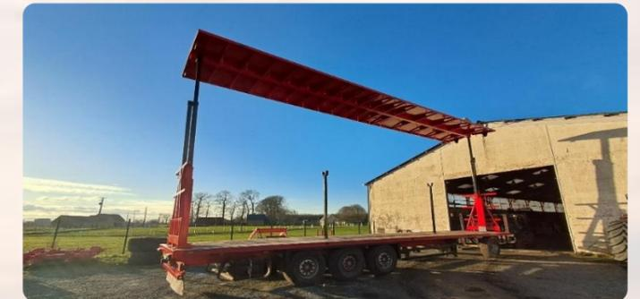
*Système sécurité balles avec levage double télescopique*
