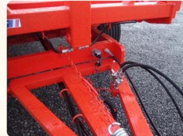
*Tube pour rangement des raccords hydraulique du système sécurité balles*
