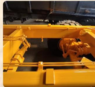
Circuit hydraulique en tube rigide
