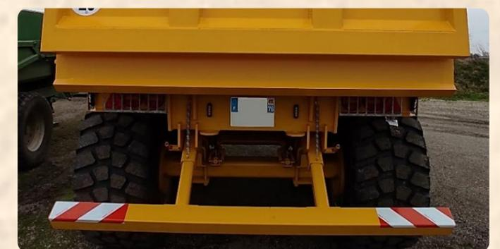
Barre anti encastrement relevable manuellement
