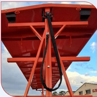
Housse de protection de flexibles (sur rallonge arrière)
