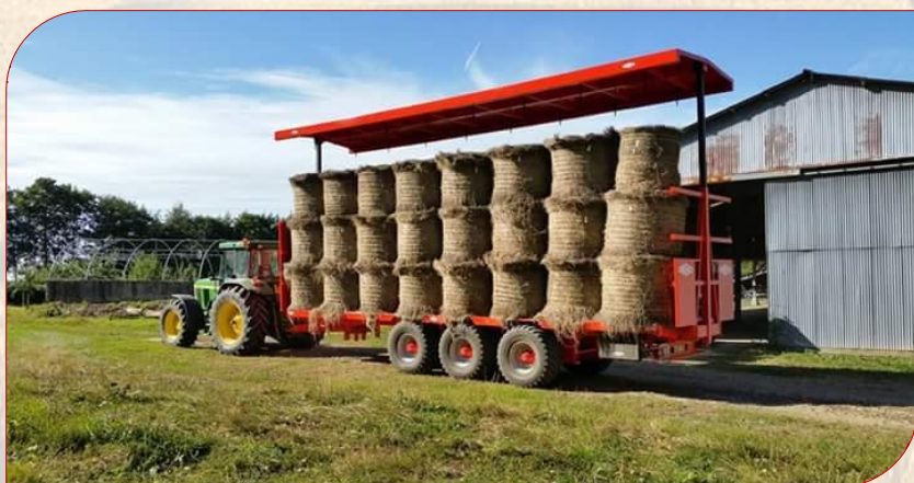
Système sécurité balles sur plateau semi-porté
