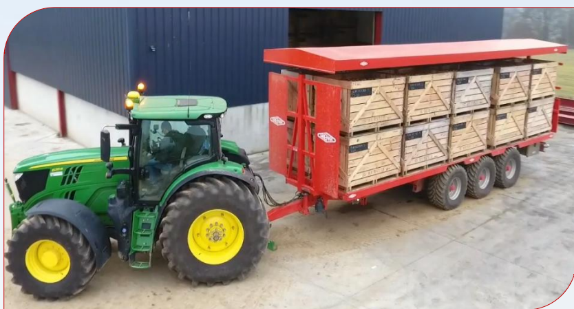
Système sécurité caisses sur plateau semi-porté
