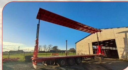
Système sécurité balles avec levage double télescopique pour l'aide au chargement
