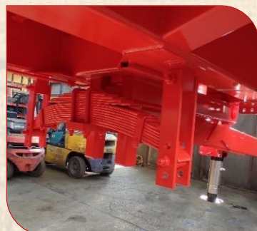
Flèche réglables sur lames de ressort
