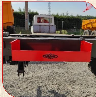
Coffre en acier ouvert (fermeture en option)
