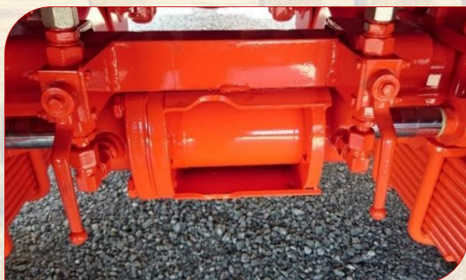
Essieu suiveur hydraulique
