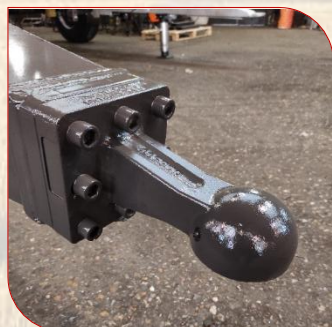
Attelage Scharmüller Boulonné K80
