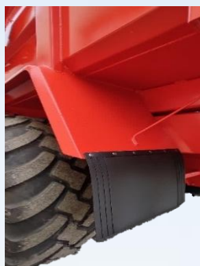
Ailes avec bordures et bavettes en caoutchoucs
