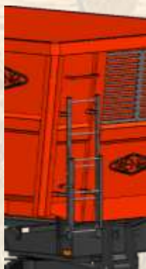
Échelle extérieure galvanisée
