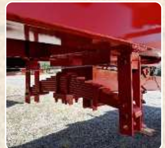
Flèche réglables sur lames de ressort
