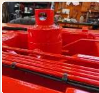
Vérin de levage de caisse
