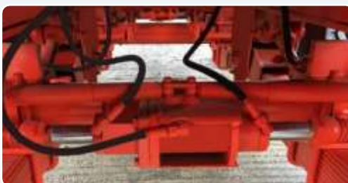
Essieu suiveur forcé avec tôle de protection sur la flèche
