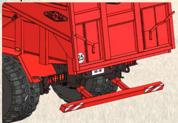
Barre anti encastrément carré relevable manuellement
