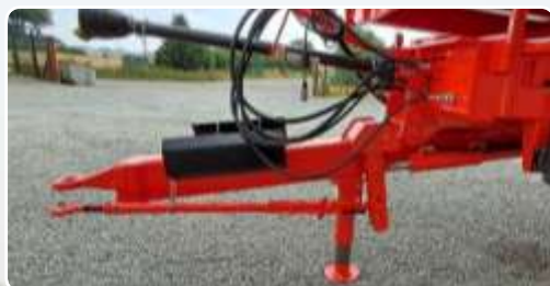
Essieu suiveur forcé avec tôle de protection sur la flèche
