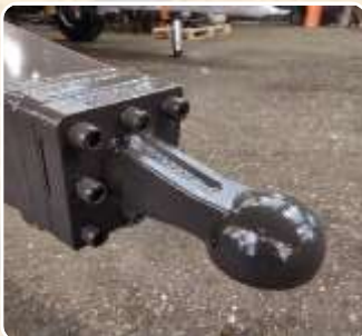
Attelage Scharmüller Boulonné K80
