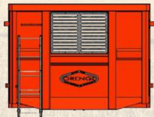
Devant avec grande ouverture et tôle d'acier (galvanisée)
