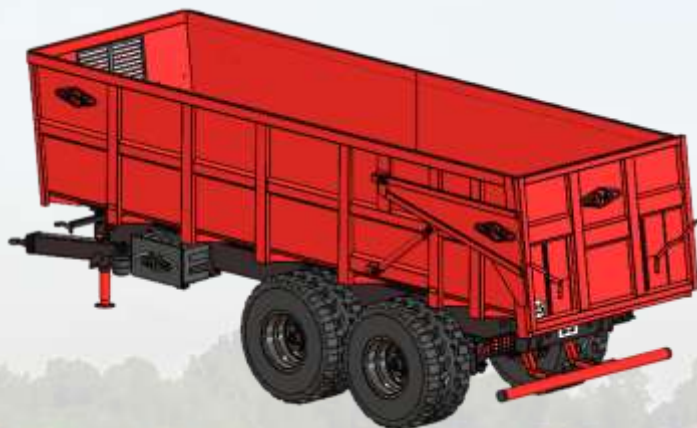
Barre anti encastrément hydraulique
