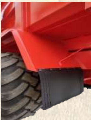
Ailes avec bordures et bavettes en caoutchoucs
