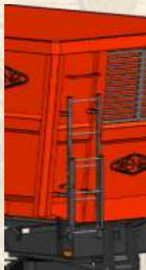
Échelle extérieure galvanisée
