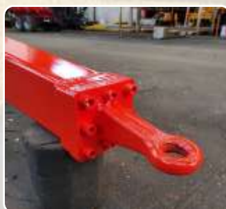
Attelage Scharmüller Boulonné anneau
