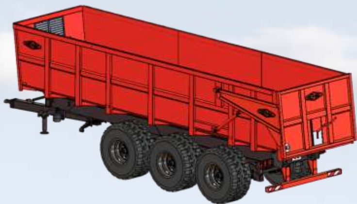
Barre anti encastrément fixe boulonnée
