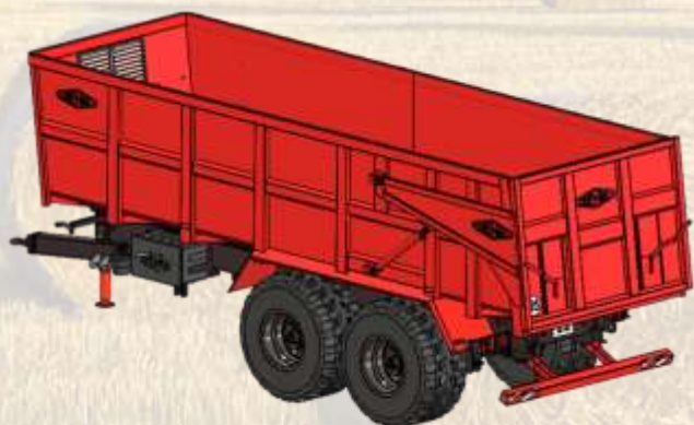
Barre anti encastrément carré relevable manuellement
