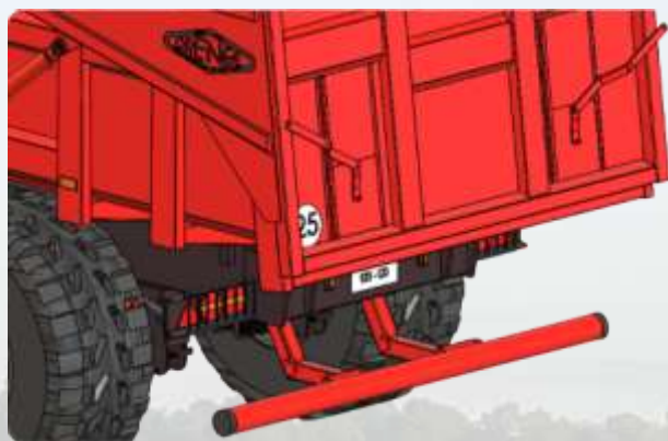
Barre anti encastrément ronde relevable manuellement
