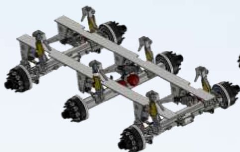
• Tridem à suspensions hydraulique ou pneumatique
